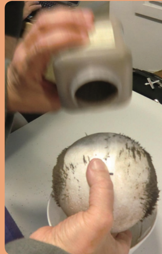
Figuras 15 e 16: As limaduras de ferro sobre a terra imantada, marcarán a dirección dos polos e como recollerán moitas máis limaduras nesta zona que no ecuador se poderá comprobar que o campo magnético é máis forte nos polos que no ecuador.
