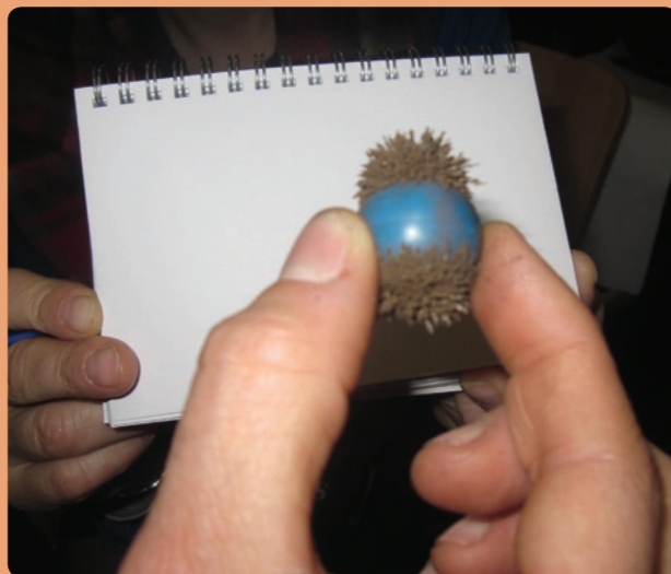
Figura 13: Os polos corresponden á zona con máis limaduras, xa que é a zona con maior densidade de liñas de forza.
