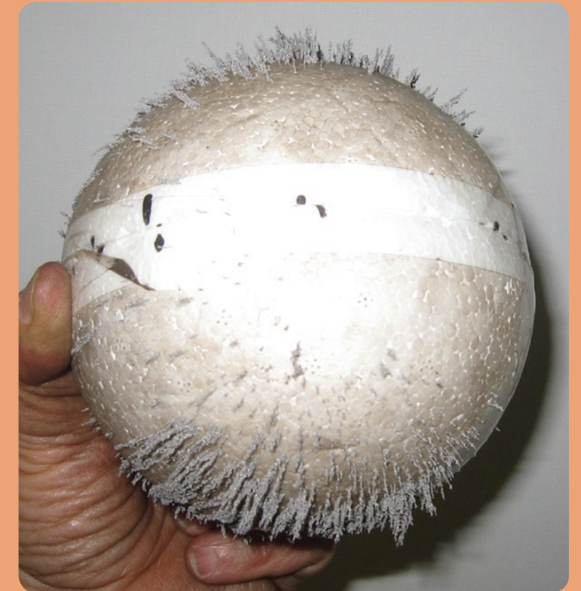
Figuras 15 e 16: As limaduras de ferro sobre a terra imantada, marcarán a dirección dos polos e como recollerán moitas máis limaduras nesta zona que no ecuador se poderá comprobar que o campo magnético é máis forte nos polos que no ecuador.
