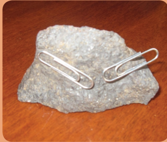
8. irudia: Magnetita zati batez erakarritako klipak.
