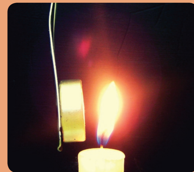
24. irudia: Kandelaren gar bertikala, imanik gabe. 25. irudia: Desbideratuta garra imana gertu duenean.
