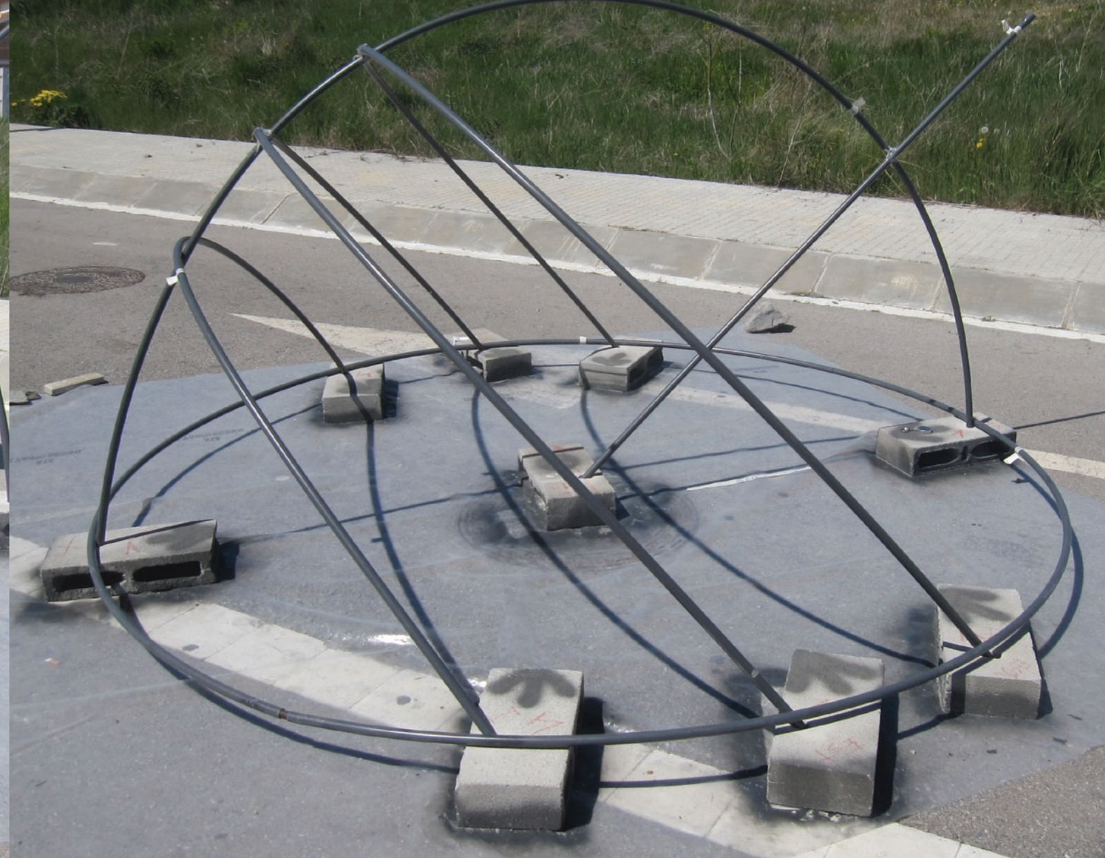
Figura 22: Model amb els paral·lels de Càncer, Capricorn i l'equador, a més del meridià local i l'eix de rotació. Sobre els blocs de ciment s'ha situat un últim tub en forma de cercle que representa l'horitzó i dona solidesa al model.
